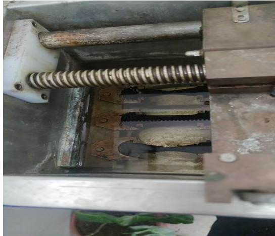
Figure IV.18 : L'emplacement des éprouvettes dans le ductilimètre (photo originale).
