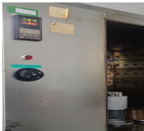
Figure IV-24 : Placement des tubes dans l'étuve pendant 72h à 180°C (photo originale).
