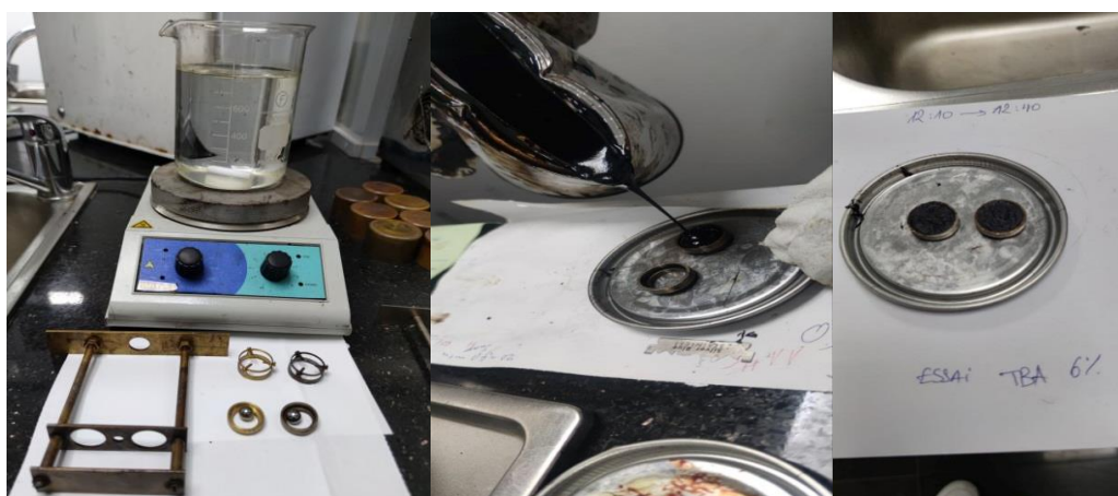
Figure IV.6: Préparation des échantillons dans les anneaux (photos originales).
