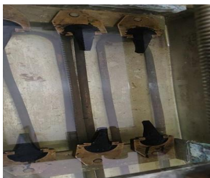
Figure IV.21 : Retour élastique des éprouvettes (photo originale).
