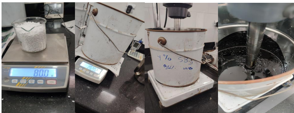
Figure IV.3 : Modification du bitume pur par SBS (photo originale).
