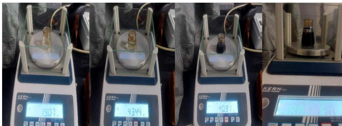
Figure IV.13 : Les étapes de l'essai de densité (photo originale).
