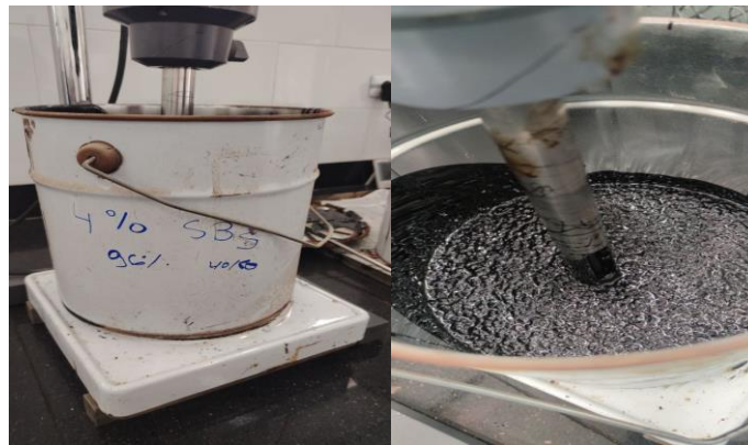
Figure IV-16 : Malaxeur de bitume modifiés par (SBS) (photo original).
