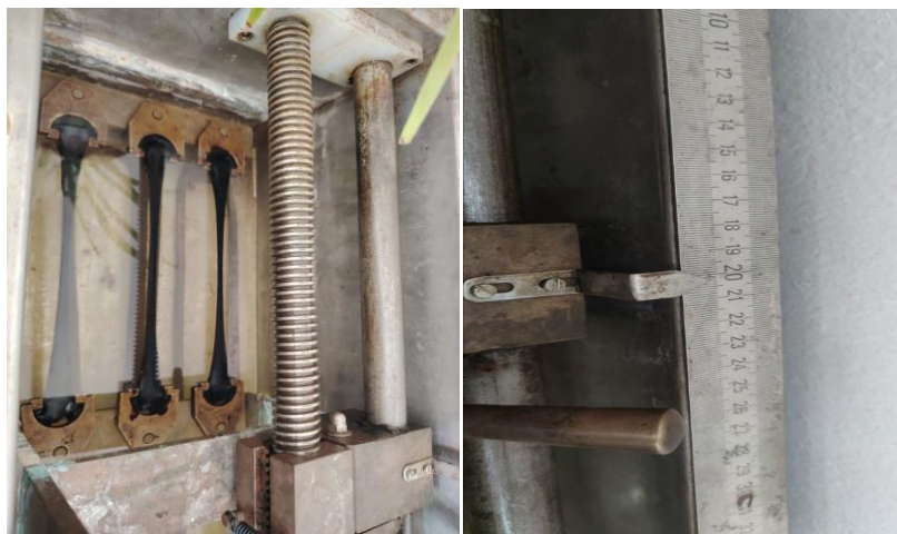
Figure IV-19 : Etirement des éprouvettes à 200 mm (photo original).
