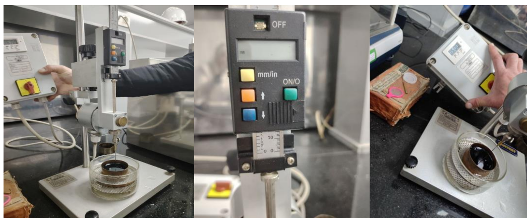
Figure IV.5 : Pénétromètre (photo originale).
