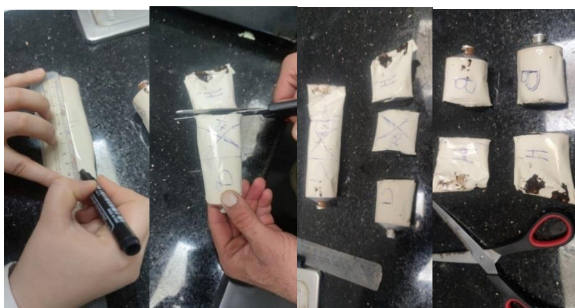
Figure IV.25 : Placement et découpage des tubes en trois portions (photo originale).
