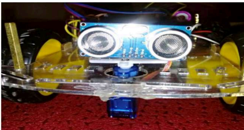
Figure50 : Branchement capteur ultrasonique et servo moteur
