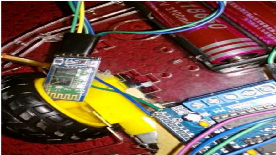
Figure49 : Branchement module Bluetooth et Arduino
