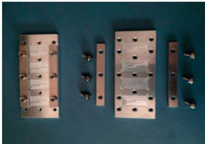
Figure III.4: Porte d'échantillon utilisé pour l'irradiation des couches Zr_{70}Ni_{30} au GANIL. À gauche : porte-échantillon assemblé. À droite : pièces à monter.
